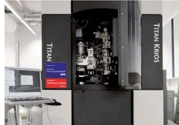
Kryo-Elektronenmikroskopie für die Bestimmung von zellulären Strukturen bei hoher Auflösung.
