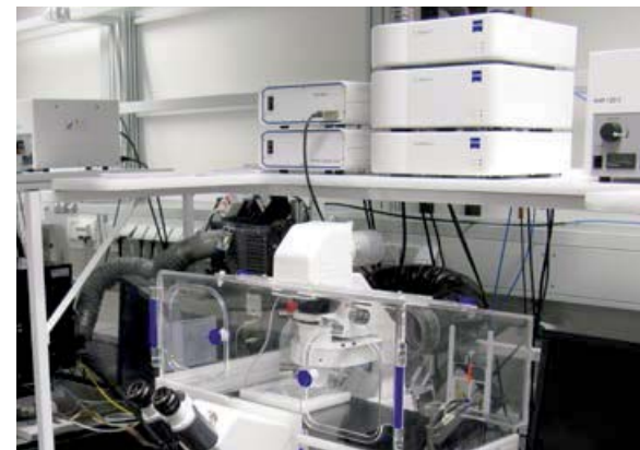
Zwei Mikroskope für Reihenuntersuchungen lebender Proben. Bis zu 1500 biologische Proben können in kurzer Zeit untersucht werden.
